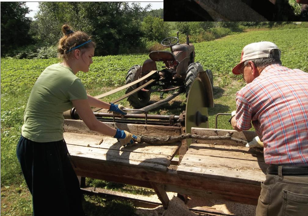
Évidemment, le travail avec le banc de scie n'est pas pour imbéciles, car un mouvement imprudent peut entraîner la perte d'un doigt ou d'un bras... En travaillant, il faut garder l'espace autour de soi propre afin d'éviter d'avoir un morceau de bois sous les pieds qui pourrait entraîner un déséquilibre.
