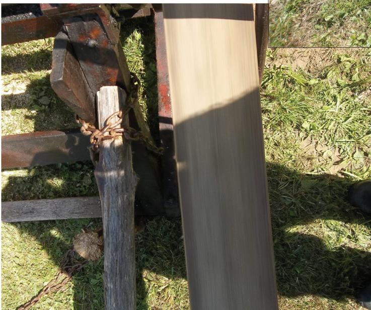
À gauche, on voit d'un autre angle l'installation de la tige de tension (avec sa chaîne attachée au banc de scie).
