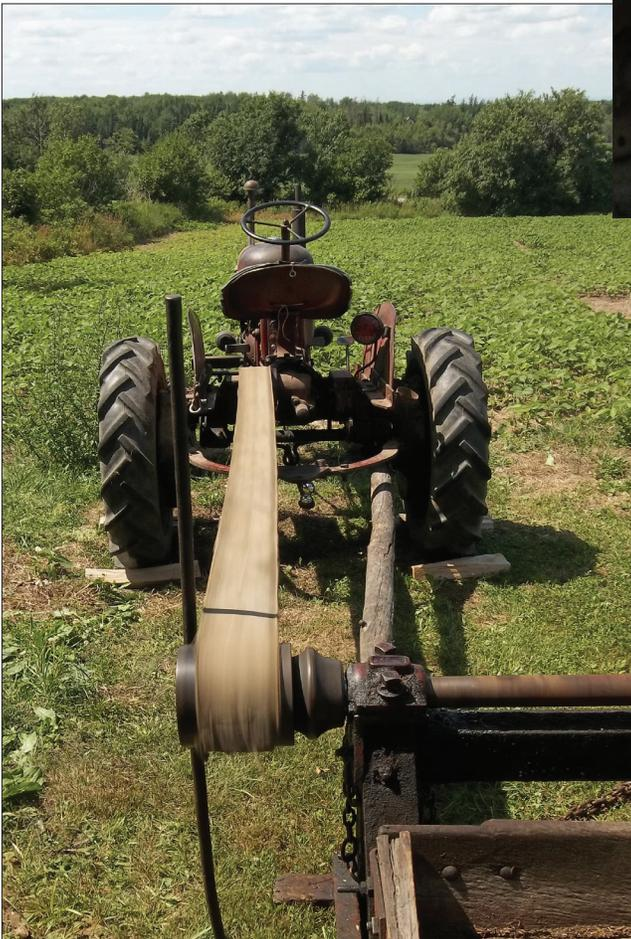
La «pince de fer», plantée dans le sol à gauche de la courroie, permet de prévenir les ballottements occasionnels de la courroie (qui peut survenir si on coupe un gros rondin trop rapidement). Il n'est pas utile que la pince touche la courroie (cela provoquerait de l'usure). Une fois la courroie installée convenablement, il faut ajouter le tendeur et appliquer une tension avec l'hydraulique du tracteur afin que la courroie ait assez de tension pour rester droite.
