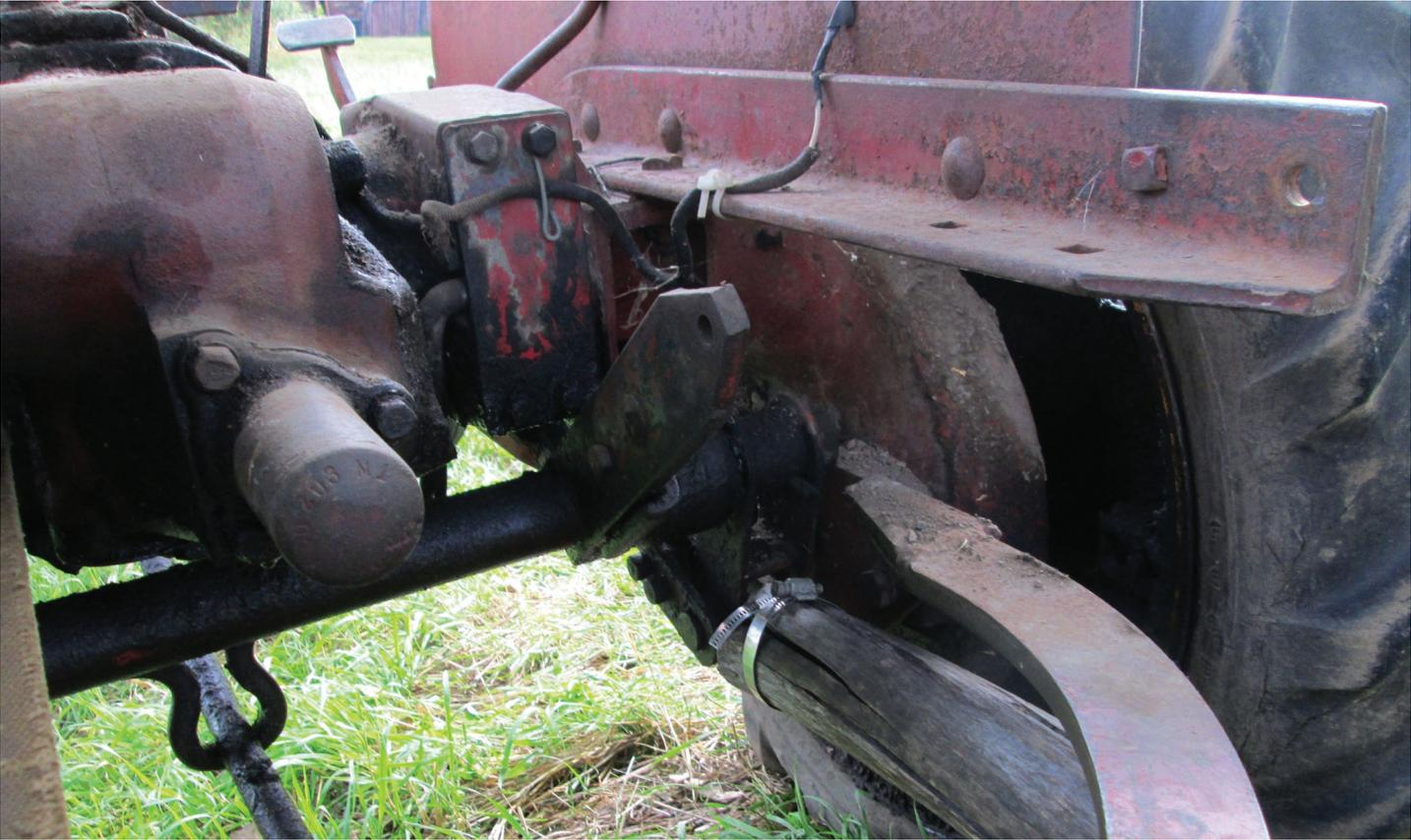
Avec ces deux photos, on voit un peu mieux comment le tendeur est accroché à l'hydraulique du *Pony*. Ce tendeur comporte une tige de bois avec un gros clou plantée dans le bout, et maintenue en place dans la tige par un collet d'acier. Une fois accroché à l'hydraulique et au banc de scie (et le tracteur en marche), il suffit d'appliquer un peu de pression avec l'hydraulique pour tendre la courroie avant de mettre en marche la scie.
